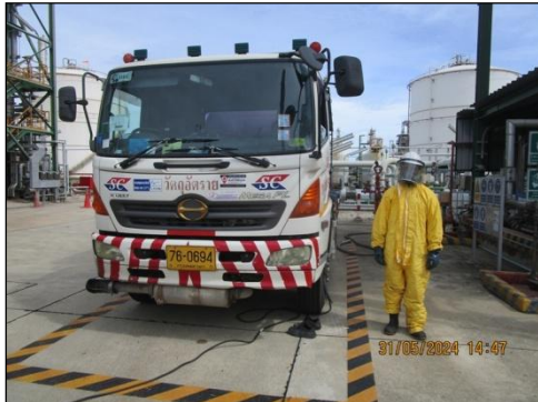
รูปที่ 3-38 เจ้าหน้าที่ดูแลขณะทำการสูบล้างสารละลายแอมโมเนียมไฮดรอกไซด์
